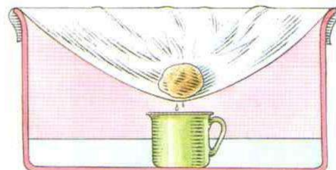
DESTILADOR DE AGUA DE MAR
