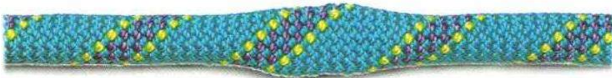
Daño en el alma. Aunque la funda no está desgastada, esta cuerda no es segura, por lo que no debería utilizarse.
