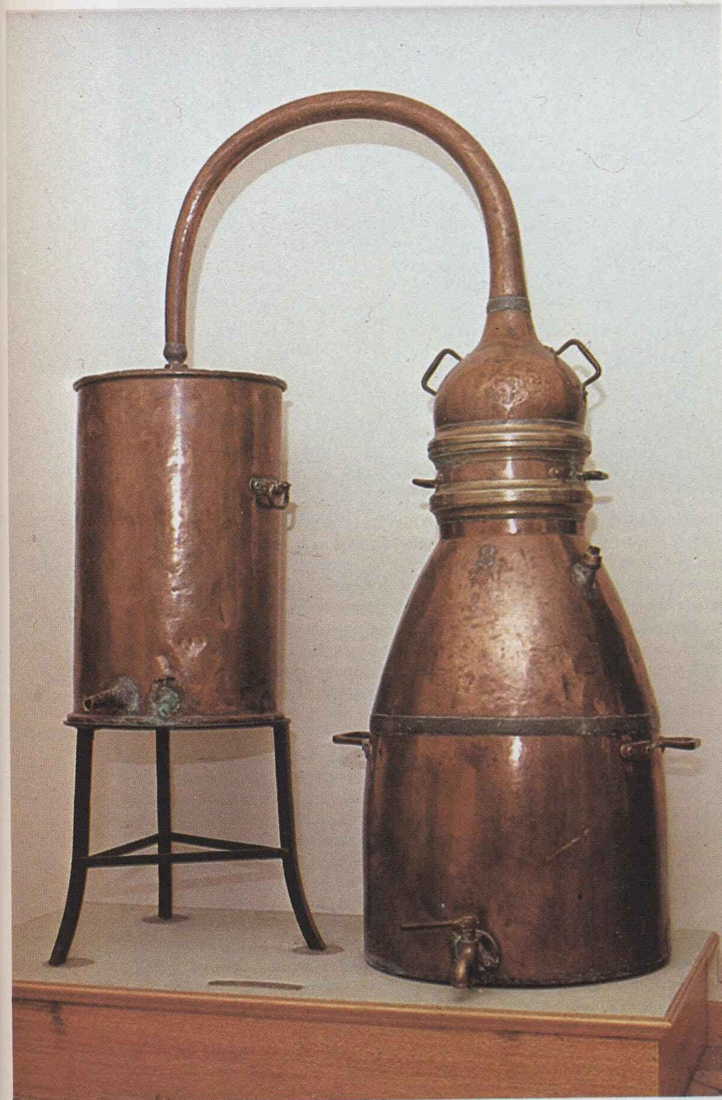
Antiguo destilador de cobre del Museo de la Perfumería Fragonard, en Grasse (Costa Azul). Se distinguen fácilmente la caldera (a la derecha), la tapa y el refrigerante (a la izquierda).
